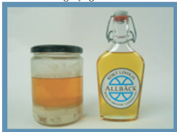
Das Öl ist entsleimt, sterilisiert und filtriert.
